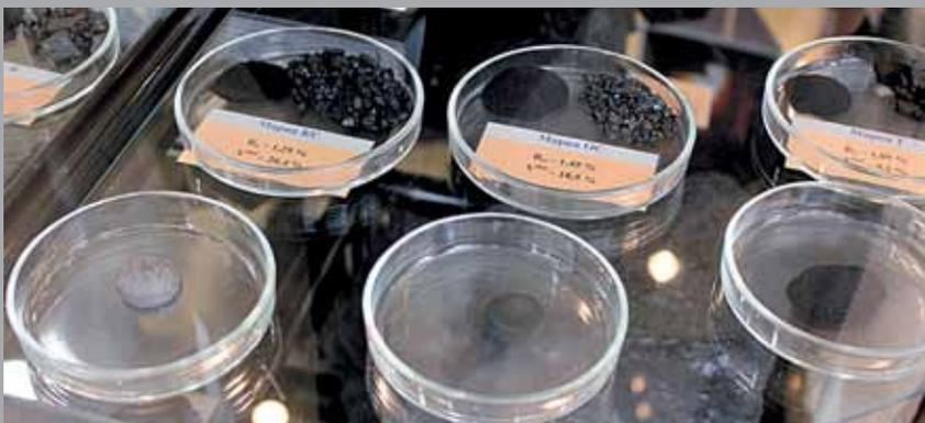
Демонстрационный ряд лабораторных проб, транслирующий коксуемые свойства углей различных марок
